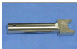
こて先 → SS150-K 使用可能はんだこて 200 W こて先挿入部径φ 16mm 以上
